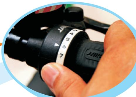
在行駛中試驗變速器的變速功能是否正常，能不能順暢的變速。
