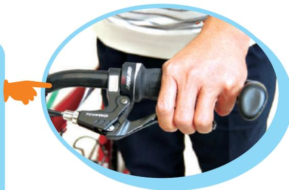
將腳踏自行車往前推，並用雙手按住煞車拉桿，試驗左右兩邊有沒有煞車作用。
