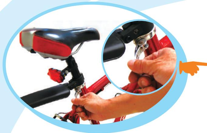
用手將座墊托架的鎖桿放鬆，無鎖桿者必須使用適當工具旋鬆固定螺帽，並依身高調整至適當位置。
